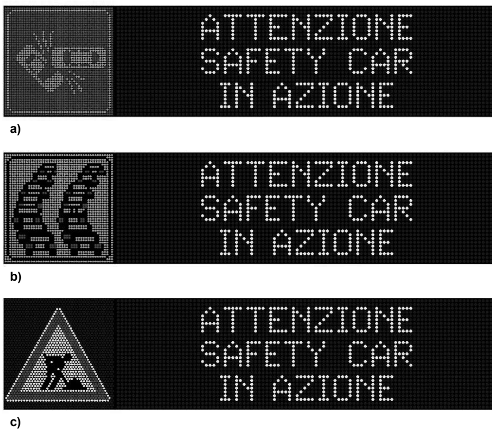
Fig. 5: Indicazione del presegnalamento del dispositivo safety car su pannello a messaggio variabile a tre righe di testo, riportante esempi di indicazione della potenziale situazione di pericolo presente sul tratto stradale.
